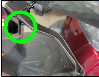
Le frein à main dispose d'une gâchette (Encerclée sur la photo ci-dessus) qui permet une fois enclenchée de maintenir le système de freinage en action. Cette fonction peut s'avérer particulièrement pratique lorsque vous désirez vous immobiliser à un emplacement en pente.
