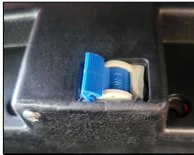
Le disjoncteur se situe dans le coffre en dessous du siège. C'est pourquoi pour accéder au coffre vous aurez besoin de votre clé pour déverrouiller le siège.
